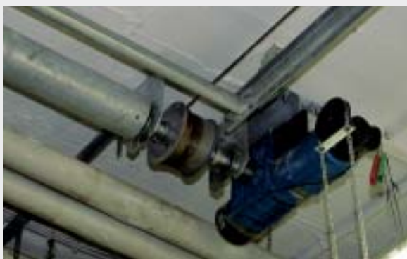
Albero a tubi con albero motore elettrico IP 65 montato sul retro (senza molla di torsione)
