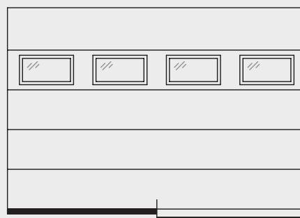
707 Pannelli Sandwich in acciaio in 5 sezioni, sezione 4 con lastre di vetro rettangolari (vetratura in plastica) con suddivisione speciale.
