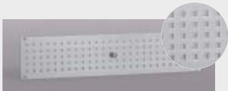
Lamiera di aerazione in alluminio con cursore con fori rettangolari da 7 mm 400 x 90 mm richiudibile dall'interno, 63,7 cm 2 trasversale di aerazione
